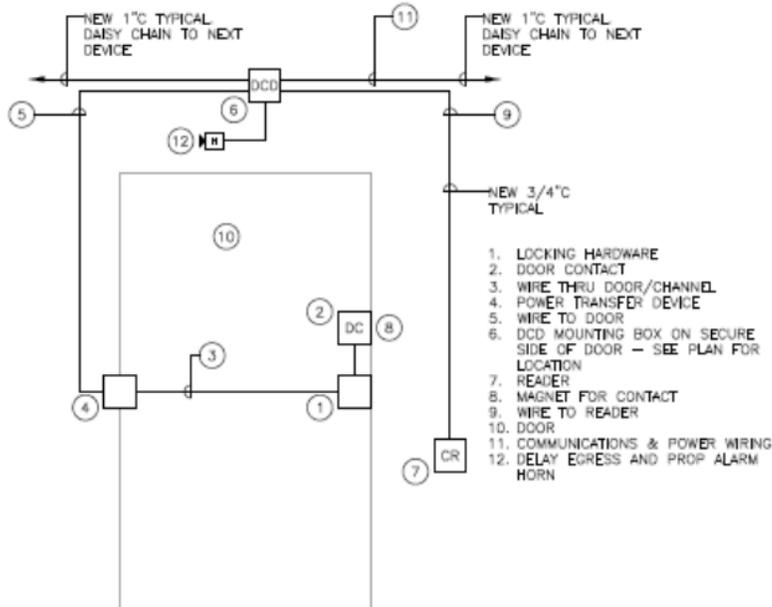
**2A** TYPICAL ACCESS CONTROL DIAGRAM - FIRE ESCAPE DOORS
